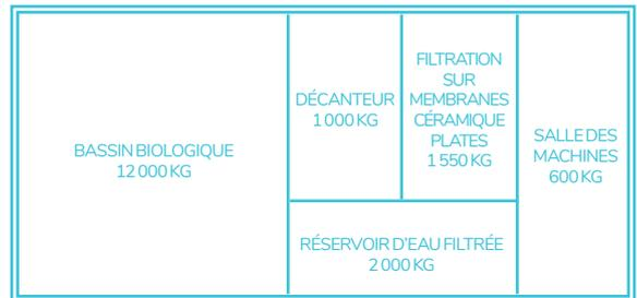
SCHÉMA D'UNE STATION EN CONTAINER
