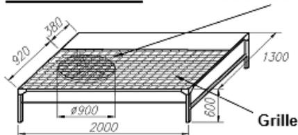
Prise d'aspiration (plusieurs points d'aspiration possible en fonction de votre configuration), une seule prise à raccorder par unité (des obturateurs sont fournis).
