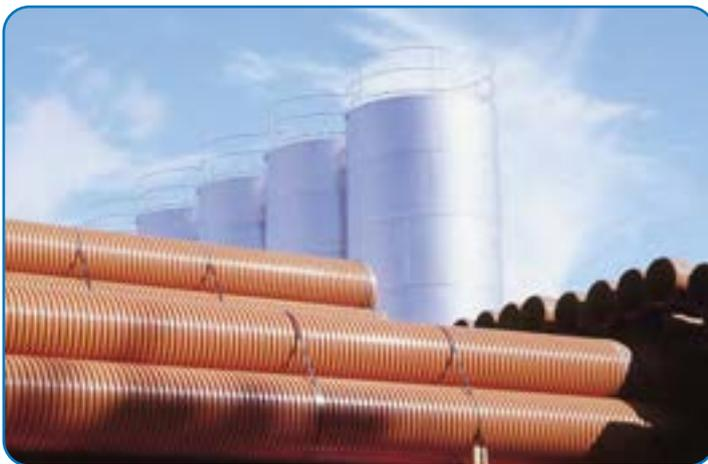
Les **tuyaux SANECOR®** sont constitués d'une **paroi structurée à double couche, lisse à l'intérieur et ondulée à l'extérieur** dans les diamètres nominaux DN160 - DN1 200 mm et sont conçus pour être utilisés dans les réseaux d'assainissement urbain, les collecteurs d'eaux usées et, en général, les canalisations transportant des solutions acides ou alcalines.
