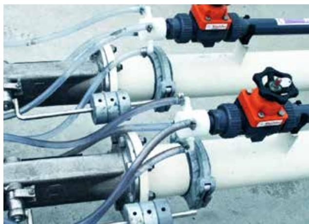
Mélangeur Venturi, système de floculation en ligne
