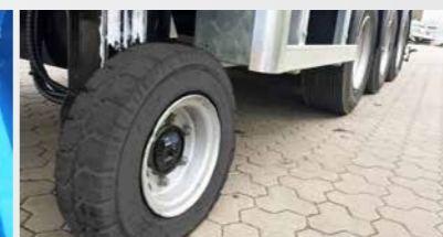
Dispositif d'avancement - permet une avance autonome de la machine grâce à un équipement radio (uniquement pour semi-remorque)
