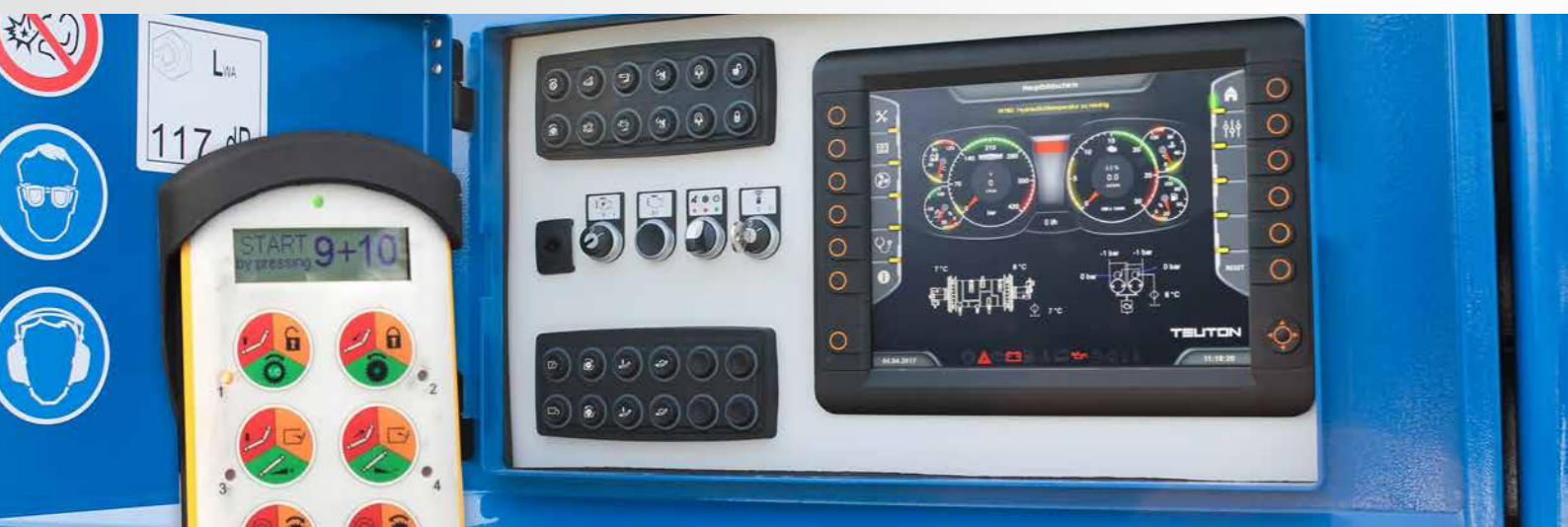
Commande IFM avec Touch Panel de 12,1" + équipement radio avec display
