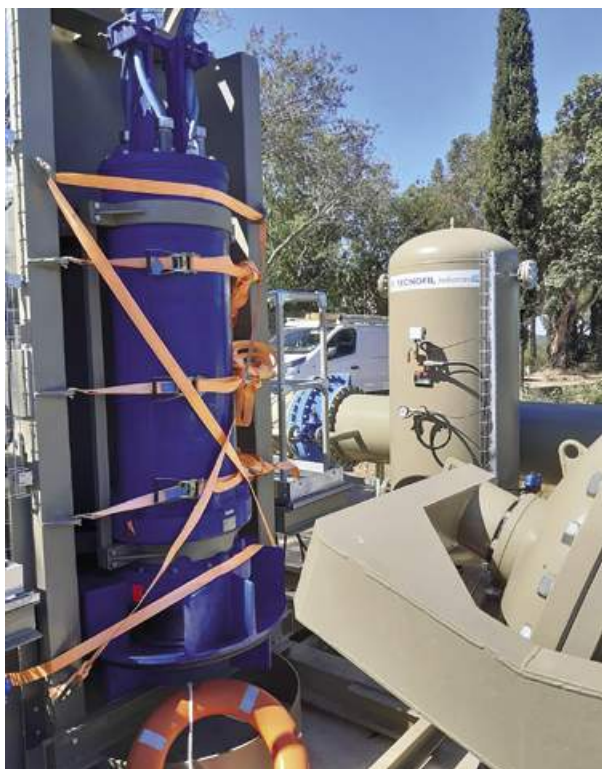
La pompe submersible en tube AMACAN K 1200-630 / 260 6 UNG1, étudiée pour un fonctionnement en position inclinée en bassin pour la restitution de l'exhaure, choisie pour sa fiabilité et sa durabilité.
