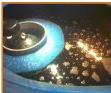
Figure 2 : Mousse coalescente (modèle SPEHD) - Consommable
