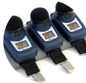
Les chargeurs 3 triphasés peuvent être raccordés ensemble et servir également de station de téléchargement
