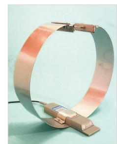
Le support de montage **DCO-FIX2** vous permet d'installer l'instrument dans des conduites de Dimensions différentes. La bande est suffisamment flexible pour s'adapter à des formes irrégulières telles que des sections ovoïdes. Tous les composants sont en acier inoxydable et les raccords de bande ont une largeur de 100 mm pour correspondre au support de montage **DCO-FIX1**.
