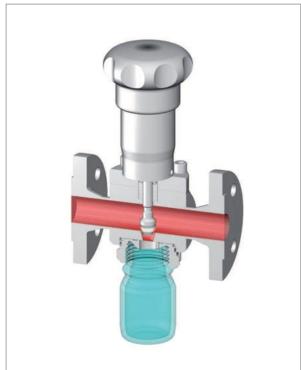
Principe du siège et pointeau coniques
