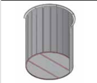
Plancher en PRV
