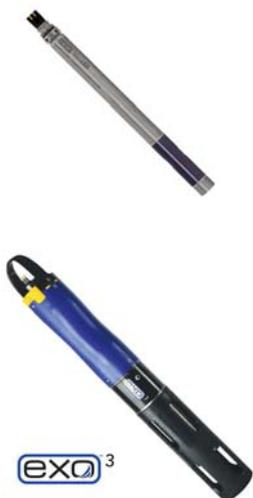
Ce nouveau capteur optique pour les sondes YSI ExO mesure par absorbance nitrate & nitrite avec compensation d'interférence des matières organiques naturelles (NOM).
