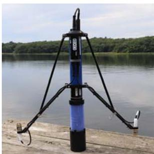
Les utilisateurs de sonde YSI ExO-2 peuvent souhaiter incorporer une mesure PAR (Photosynthetically Active Radiation). Le kit ExO-PAR consiste en 3 éléments principaux: l'adaptateur ExO-PAR et les câbles, la structure porteuse en plastique, les capteurs Li-Cor PAR.
