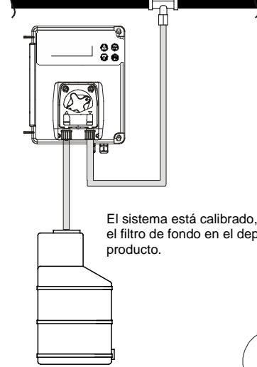
El sistema está calibrado, coloque el filtro de fondo en el depósito del producto.
