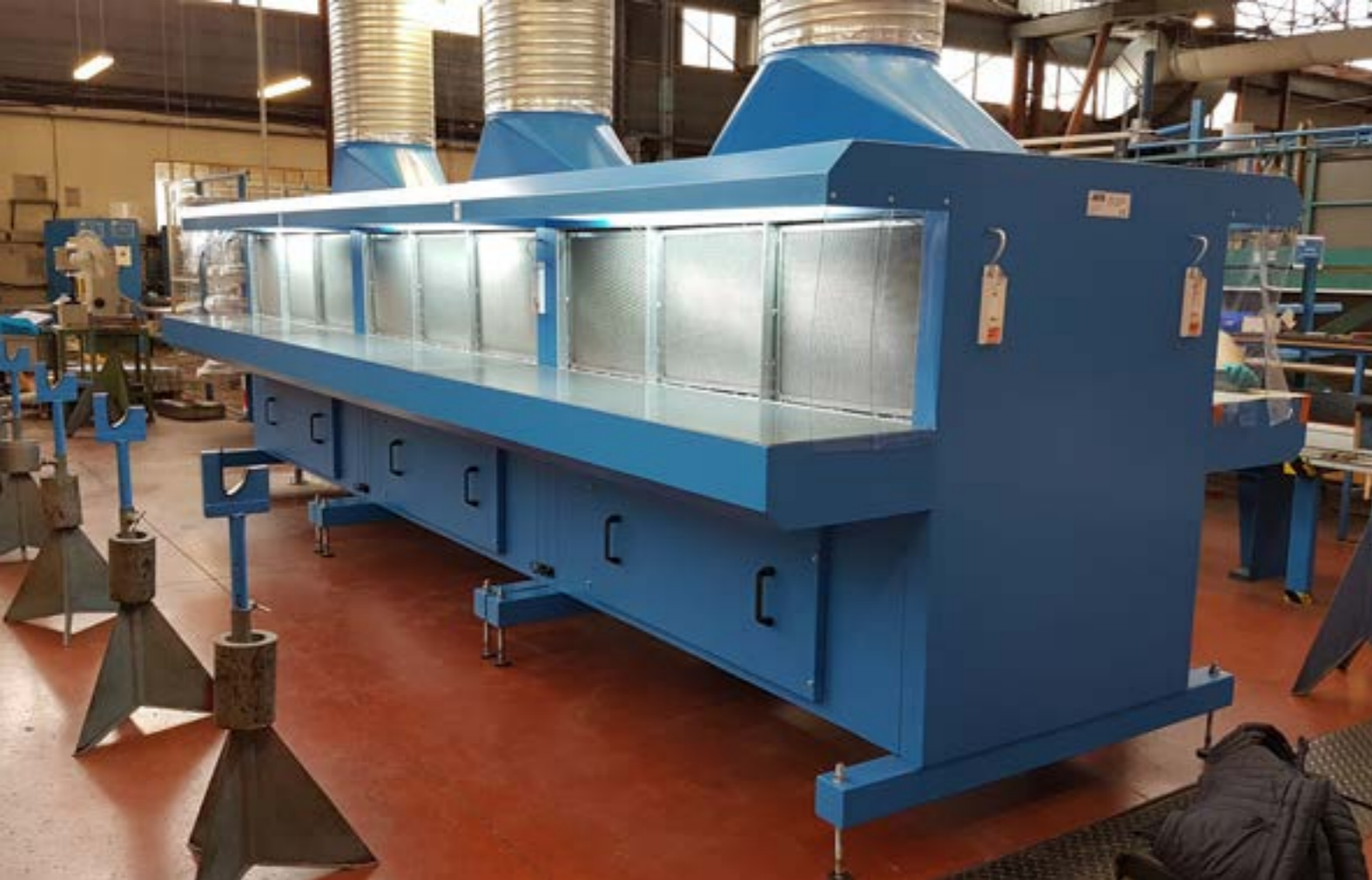
TP 600 2Df So – Plans de travail doubles - Polissage de pièces INOX grandes longueurs
