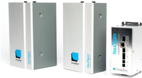
Le **générateur** NextTgen INSIDE est conçu pour s'intégrer dans les lignes automatisées et les machines spéciales afin de commander les convertisseurs ultrasons. Fournissant des puissances jusqu'à 3000W pour des fréquences de 20 à 65kHz, notre gamme de générateurs NextTgen est conçue pour répondre à de nombreux besoins industriels dans le domaine du soudage et de la découpe.
