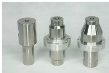
Le **booster** ou modificateur d'amplitude, permet d'augmenter ou de réduire l'amplitude vibratoire produite par le convertisseur. L'amplification ou la réduction de l'amplitude est obtenue grâce à certaines caractéristiques de conception ou à la forme géométrique du booster.
