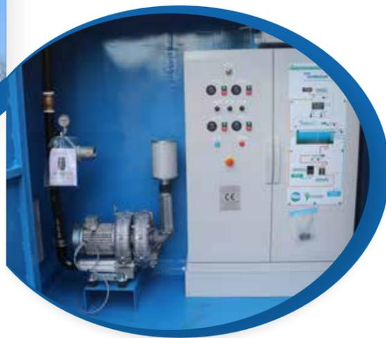
Le procédé **UniBioCell®** est une technique de traitement éprouvée reposant sur la dégradation de la pollution par des microorganismes par voie aérobie, c'est-à-dire avec apport d'oxygène. Par arrêt de l'aération, il permet la dénitrification de l'effluent.
