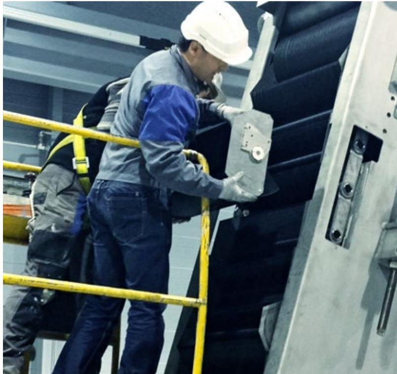
Élément de filtration démontable par l'avant
