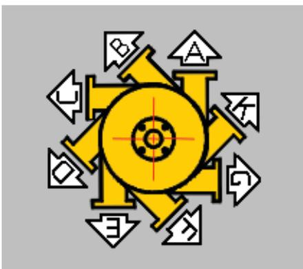
**Note :** Pour la position de refoulement A, le tuyau de refoulement doit présenter un diamètre identique à celui de l'orifice de refoulement de la pompe afin de vider le moteur. Les adaptateurs de tuyau ne doivent être installés qu'au-dessus du moteur, à moins d'utiliser un adaptateur excentrique. D'autres modèles et tailles sont disponibles sur demande.
