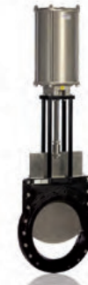
SD 2 DOMINO-Feststoffschieber/ Knife gate valve AT 200F Beidseitig dichter Plattenschieber aus GG25/GGG40 für rieselfähige Feststoffe/Stäube. Bidirectional knife gate valve made of GG25/GGG40 for free-flowing solids/dusts. Baulänge/Face-to-face dimension: EN 558-1, Reihe/Series 20 DN 50 – DN 1200, PN 10 ATEX Zertifizierung/ATEX approved for category II 1D/2GD c
