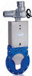
SD R DOMINO-Regelschieber/ Control knife gate valve AT 200R Regelschieber mit optimierter Regelblende zur Erzielung einer linearen Regelfunktion Control knife gate valve with an optimised control shape in order to achieve a linear control function Baulänge/Face-to-face dimension: EN 558-1, Reihe/Series 20 DN 50 – DN 1200, PN 10
