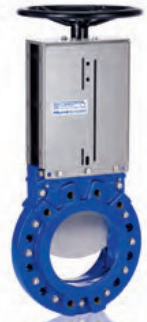
SD 3 DOMINO-Hochdruckschieber/ High pressure knife gate valve AT 300 Plattenschieber für entwässerte Klärschlämme und Biomassen. Betriebsdrücke bis zu 40 bar. Knife gate valve for drained sewage sludge and biomass. Operating pressures up to 40 bar. Baulänge/Face-to-face dimension: EN 558-1, Reihe/Series 16 DN 100 – DN 300, PN 10 – PN 40
