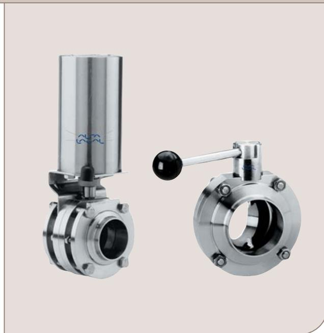
Pour le fonctionnement manuel, une poignée verrouille mécaniquement la vanne en position ouverte ou fermée. Des poignées à deux ou quatre positions, des poignées de régulation sur  $90^\circ$  et des poignées multi-positions sont disponibles. Les vannes manuelles peuvent également être montées avec des boîtiers de détection pour la rétroaction sur la position de la vanne (ouverte/fermée).
