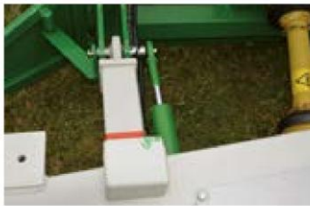
Déport hydraulique pour garder l'andain la ou il faut.
