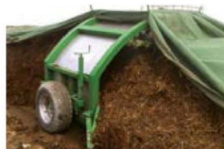
La bâche est ramené sur une petite largeur pour laisser les gazes s'échapper. Le travail physique avec des baches humides est ainsi évité.
