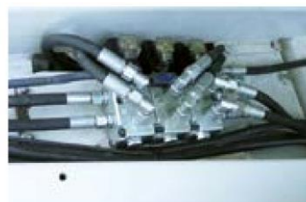
Boîtier de distributions avec electrovannes (simple, double ou triple)
