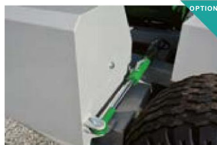
Contrepoids dépliant hydrauliquement
