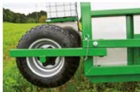
Pour le transport la roue de support peut être repliée. Pas de démontage nécessaire
