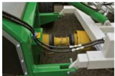
Entraînement direct grâce au réducteur sur le rotor
