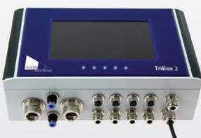
Le TriBox 3 est équipé de quatre entrées capteurs avec connecteurs M12 à vis de verrouillage.
