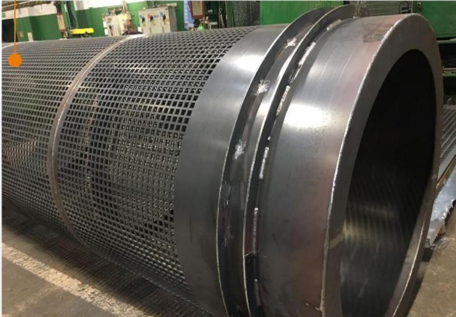
Trommel porteur recevant des segments grillagés mailles de 3 mm à 40 mm
