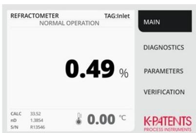
Les capteurs série PR-43 intègrent une interface utilisateur web (WI via le navigateur internet et protocole UDP/IP). Cette dernière permet d'effectuer les paramétrages, vérification et diagnostics à partir d'un PC pour les applications qui ne nécessitent pas d'affichage ou de gestion de nettoyage du prisme.
