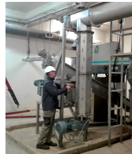
> La vis verticale laisse libre la circulation autour des machines dans un atelier
