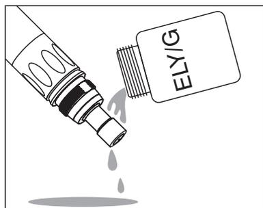
Rincer soigneusement la tête de sonde avec de la solution d'électrolyte.
