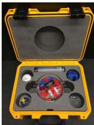
Tout l'équipement d'échantillonnage nécessaire à l'extraction SPE sur site peut facilement être transporté dans une valise rigide de protection Pelican®.
