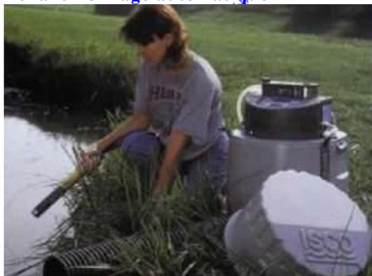
Les échantillonneurs automatiques ont été développés pour produire un échantillon de type d'eau qui représente plus que quelques secondes des dynamiques changeantes d'une rivière, d'un rejet urbain, d'un cours d'eau ou d'un bassin versant.
