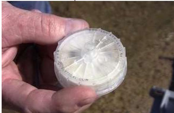
Ce media est le mieux adapté pour l'analyse des organiques semi-volatiles, Méthode EPA 1694 (produits pharmaceutiques et de soin personnel), contaminants émergents dans les eaux usées et l'eau potable. Il retient une large variété de composés polaires et non polaires tels que : SOC EPA 525, pesticides, pyréthroïdes, herbicides, bromés PBDE, analgésiques et stimulants comme la caféine.
