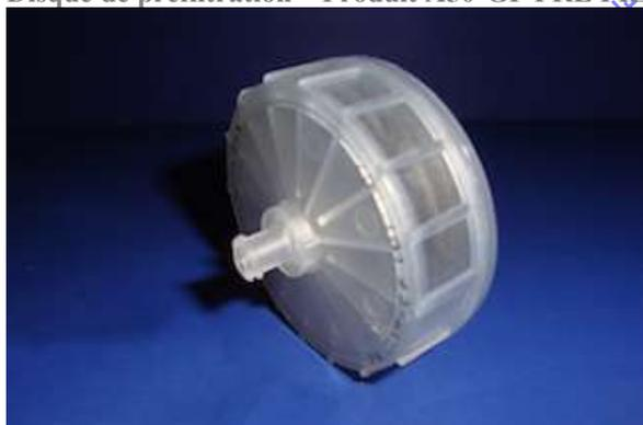
Le disque de préfiltration en fibre de verre permet des études toxicologiques pour les traces organiques totales et dissoutes. Il peut être utilisé dans un ensemble de filtre à deux étages, où le filtre en fibre de verre élimine les sédiments et permet de retenir les matières organiques solubles dans l'eau sur le filtre de type HLB ou SPE inférieur.
