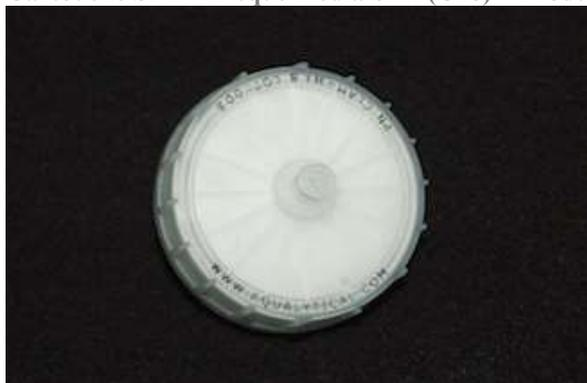
Ce milieu est le plus répandu et le mieux établi pour les composés non polaires, et les laboratoires d'analyse de l'eau ont normalisé son utilisation. De nombreuses méthodes EPA ont incorporé son utilisation, pour les pesticides, les HAP, les semi-volatiles, les PCB, les dioxines, les furanes, les PBDE et d'autres méthodes HRMS, telles que les EPA 1668 et 1614. L'huile et la graisse gravimétriques EPA 1664 peuvent même être utilisées à l'aide de ce disque média.
