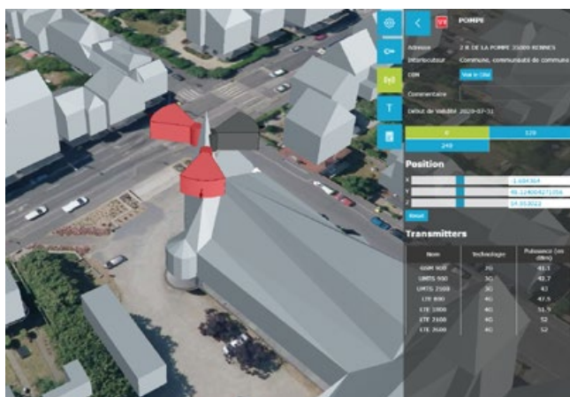
Outil de recalage et repositionnement manuel des antennes
