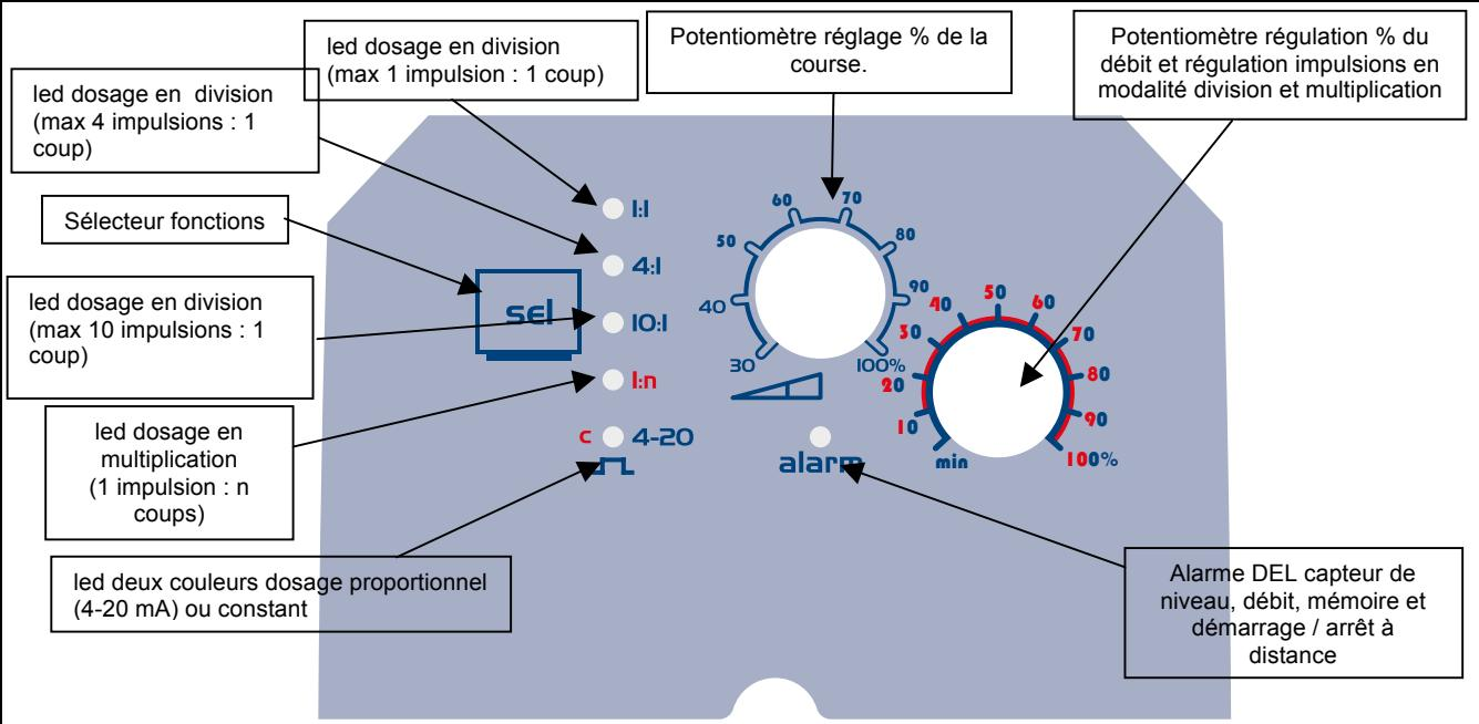
Les régulations doivent être effectuées en utilisant la poignée de réglage placée sur la face avant de la pompe
