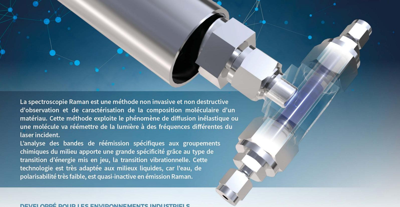
La spectroscopie Raman est une méthode non invasive et non destructive d'observation et de caractérisation de la composition moléculaire d'un matériau. Cette méthode exploite le phénomène de diffusion inélastique où une molécule va réémettre de la lumière à des fréquences différentes du laser incident.
