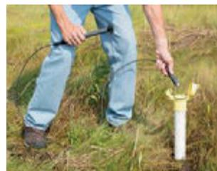
Ce capuchon de verrouillage de puits offre un montage pratique pour les enregistreurs dans les puits. Utilisé avec la partie MX2001-TOP, il permet d'attacher l'enregistreur en haut du puit pour une portée de transmission sans fil optimale.
