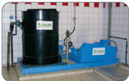
Lavage haute pression des toiles
