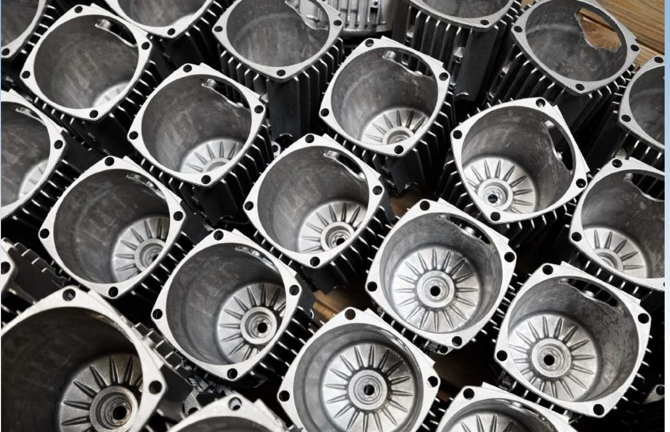
Les nouveaux composants moulés seront bientôt soumis au système de traitement de surface CED de Grundfos
