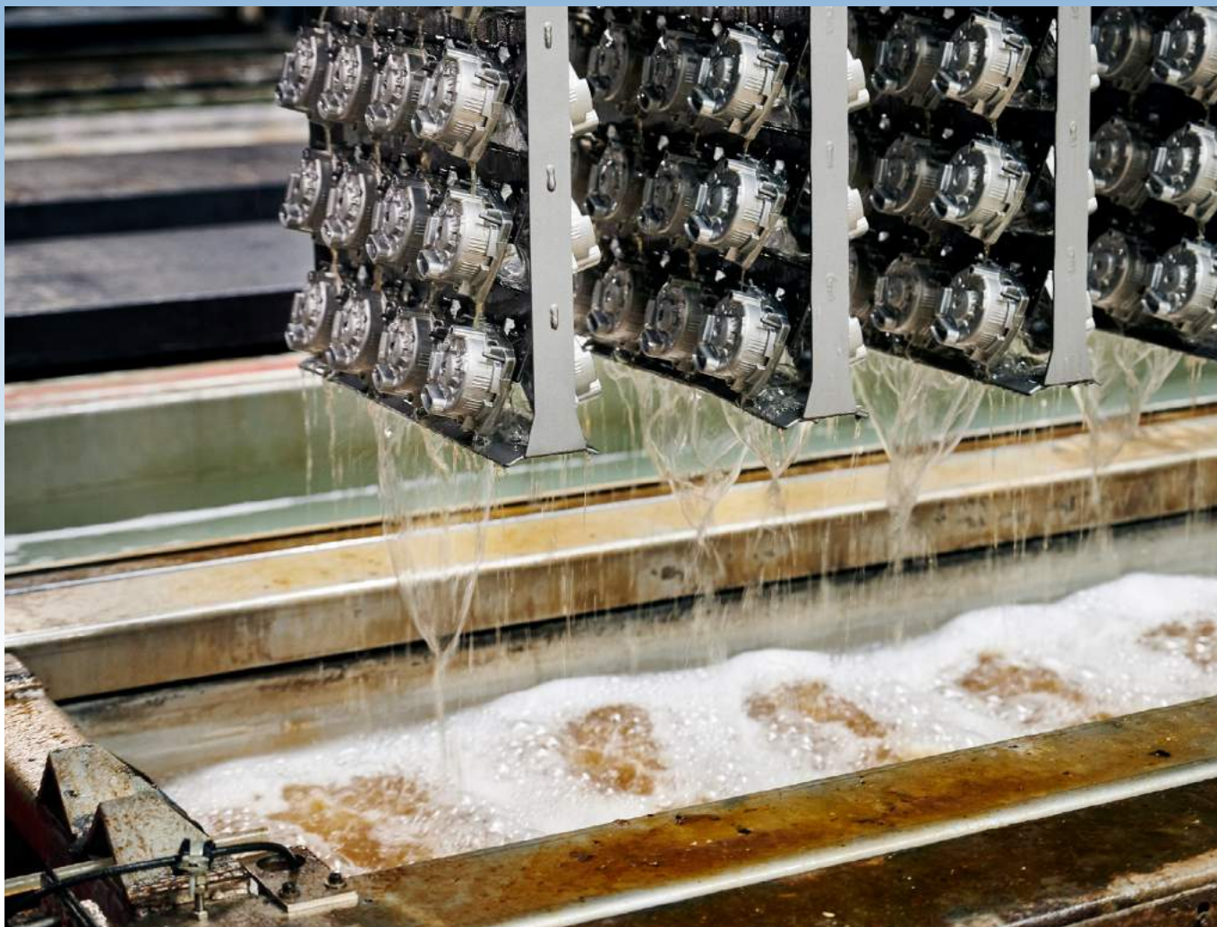
Une série de nouveaux composants moulés s'élève du premier bain de rinçage du système de traitement de surface CED de l'usine Grundfos de Bjerringbro.
