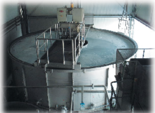
KLC 24 - Traitement d'eau de process (industrie textile)
