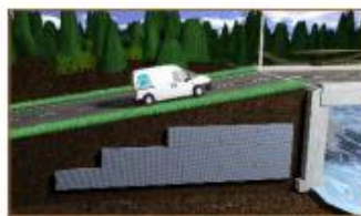
REMBLAI SUR VERSANT INSTABLE
