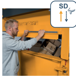
Porte guillotine Porte à ouverture automatique et fermeture manuelle
