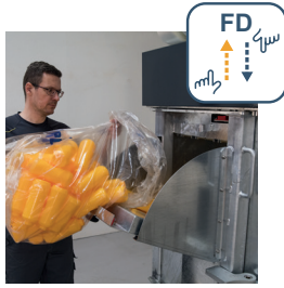
Porte abattant Porte à ouverture et fermeture avec abattant
