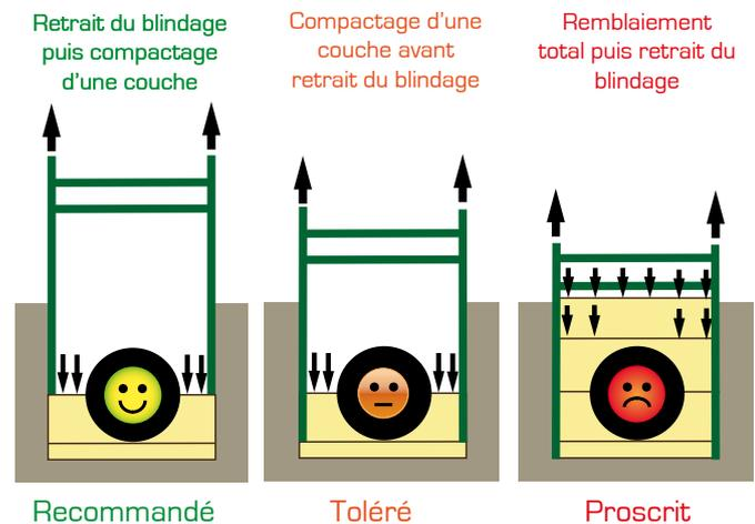
Sauf recommandation contraire, le matériel excavé pour creuser la tranchée peut être réutilisé comme remblai, au-dessus du niveau supérieur requis du matériau de remplissage latéral sélectionné.
