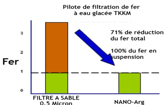
Fer et manganèse sont communément présents dans les eaux souterraines comme ions divalents. En présence de chlore ou d'air, ils se précipitent sur la surface des membranes.
