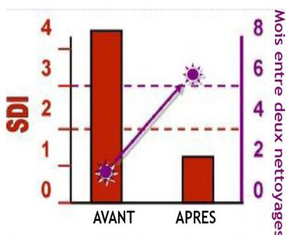
Les cartouches de filtration NANO-Arg sont actuellement utilisées par TOYOTA Motors comme préfiltres final sur un système d'osmose inverse alimenté par une eau de forage particulièrement difficile. Les changements d'éléments membranaires y étaient effectués 6 à 7 fois par an !
