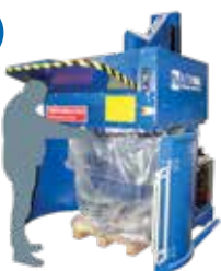
Mise en place de la housse
