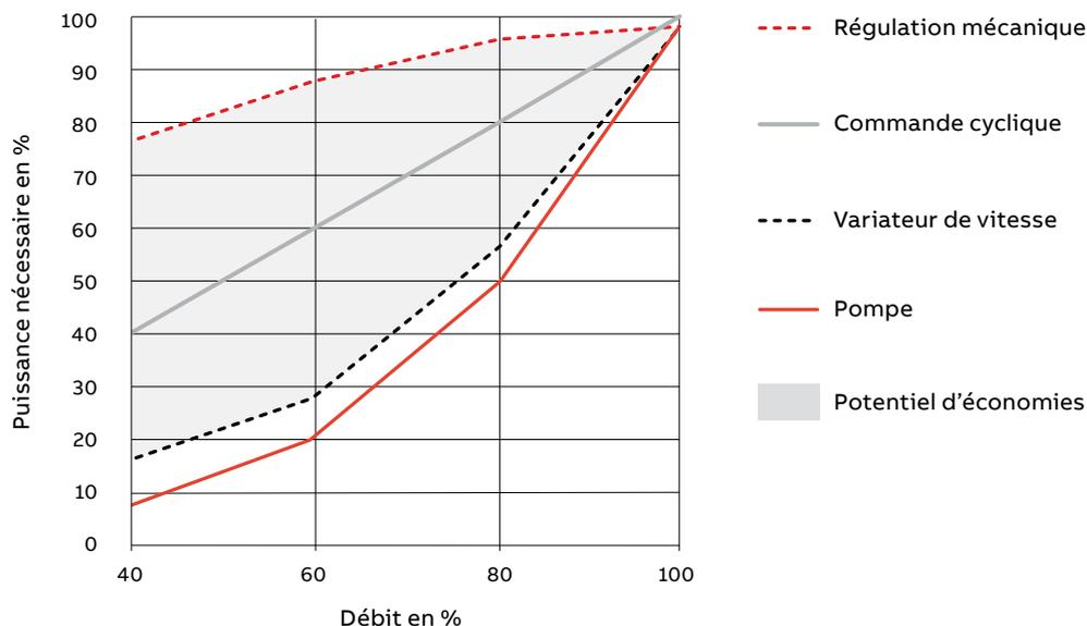
Il est également possible d'ajouter des VSD aux moteurs déjà présents dans un système de pompage afin d'améliorer leur efficacité énergétique. De manière générale, l'ajout d'un VSD au moteur existant d'une pompe, d'un ventilateur ou d'un compresseur permet de réduire sa consommation d'énergie de 25 %.<sup>15</sup>
