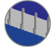
En supplément à la pression hydrostatique (plus une marge de sécurité de 35 %), une charge supplémentaire de 10/20/30 KN/m<sup>2</sup> est appliquée sur le mètre supérieur de la hauteur de retenue d'eau.
