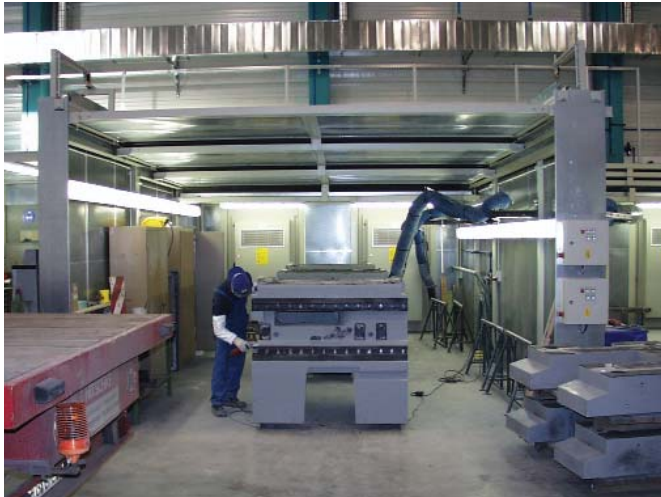
Ponçage de béton polymère (bâti de machine)
