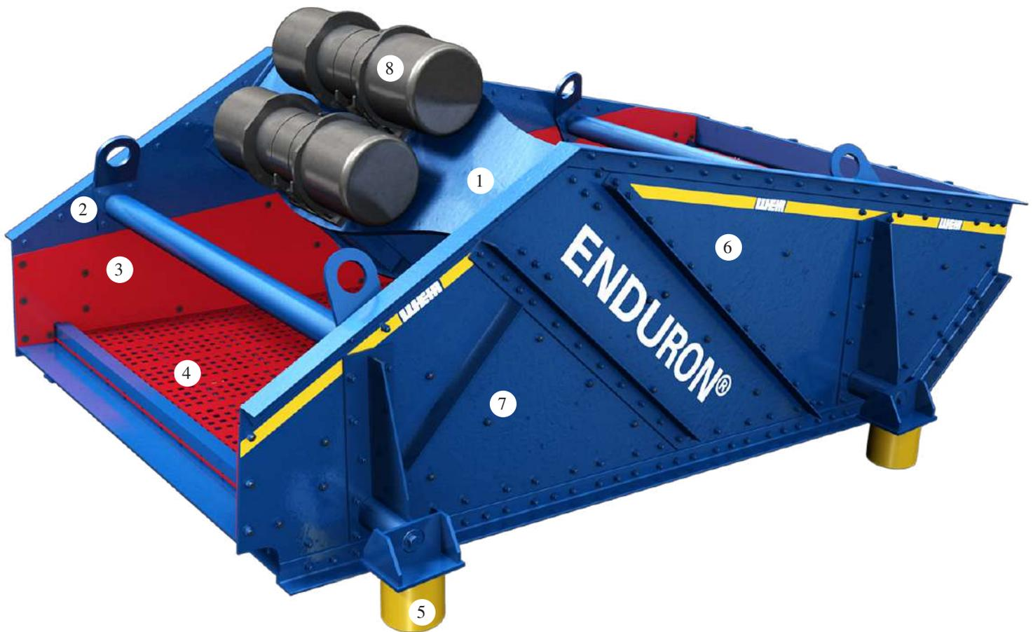
1. Le pont de l'excitateur principal, composant vital de la transmission de la vibration du moteur vibrant au crible, est libéré de toute tension. Les surfaces d'accouplement avec les plaques latérales du crible et les moteurs sont usinées de manière à respecter les tolérances et assurer un ajustement précis pour garantir une plus longue durée de vie.
