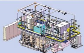
En filtration individuelle ou centralisée, le filtre à dépression répondra à tous vos besoins : Il peut filtrer tout type d'usinage et de produit. Capable d'une filtration allant de 50µ jusqu'à 20µ ou 10µ en filtration fine équipé d'une refiltration.
