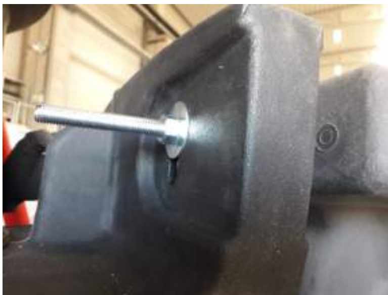
Fig-12 : fixation à un filtre compact x-perco® R-90 monobloc
