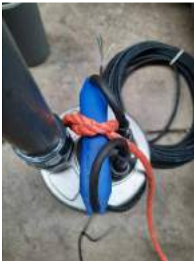
Fig-22a : corde à l'extrémité de l'œillet du tampon
