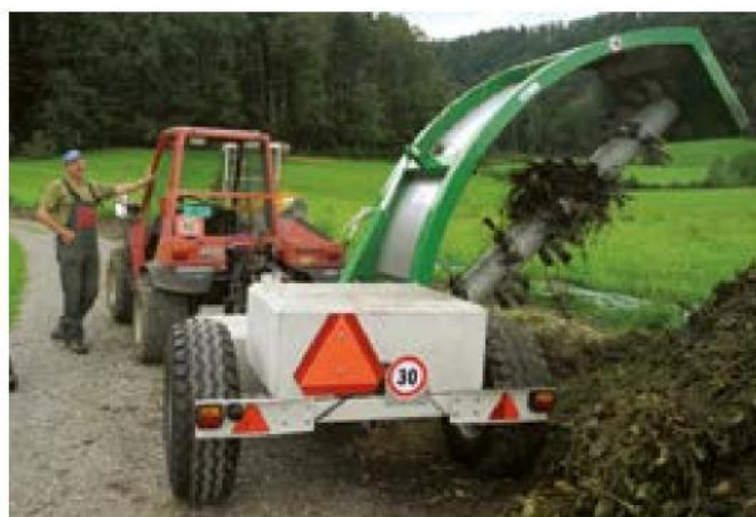
A la fin du chantier le tunnel est mis facilement en position de transport.
