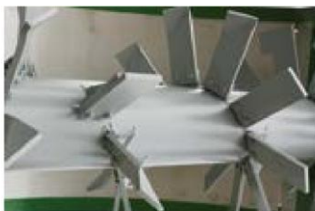
Un bon rotor travaille la matière de l'intérieur vers l'extérieur pour optimiser les conditions de vie des microorganismes.
