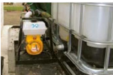
Les retourneurs sont conçues d'une façon à permettre d'installer des pompes à eau individuelles.
