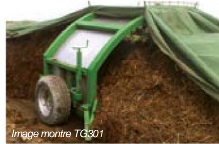
La bâche est ramenée sur une petite largeur pour laisser les gazes s'échapper. Le travail physique avec des baches humides est ainsi évité.
