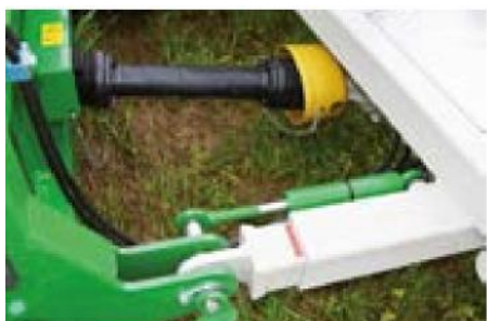
Entrainement direct grâce au réducteur sur le rotor
