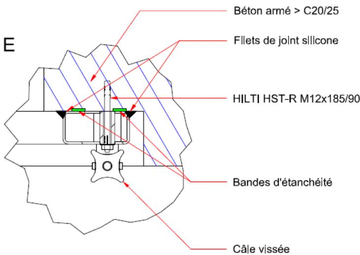
Principe d'ancrage appliqué sur les côtés gauche et droit du cadre
