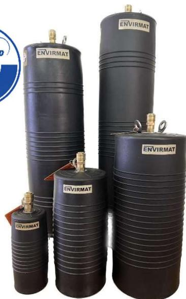
Ces obturateurs sont fabriqués avec un caoutchouc spécial renforcé par un tissu Kevlar. Ces produits de test sont principalement employés pour l'étanchéité des réseaux d'égouts. De nombreux formats sont disponibles, allant du  $\varnothing 35$  au  $\varnothing 2800$ mm. Tous les obturateurs sont équipés de raccords rapides et d'embouts de connexion en matériaux résistants à la corrosion.
